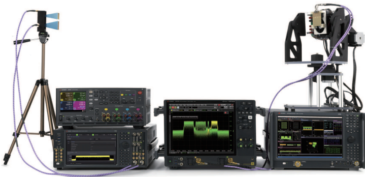
5G NR 28GHz MIMO Test Setup
