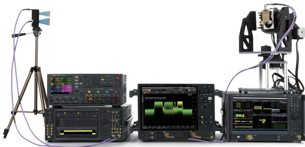
5G NR 28GHz MIMO Test Setup
