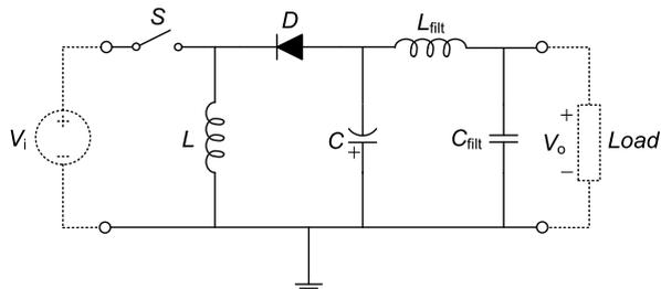
(d) Buck-boost voltage converter with output filter
