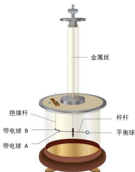
图 4 库仑扭秤的结构
